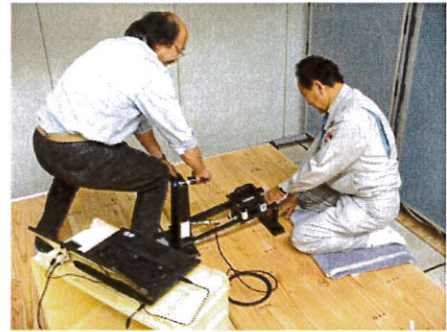
写真3 携帯型床の滑り試験機による試験
